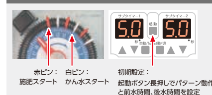
赤ピン: 施肥スタート 白ピン: かん水スタート 初期設定: 起動ボタン長押しでパターン動作と前水時間、後水時間を設定
